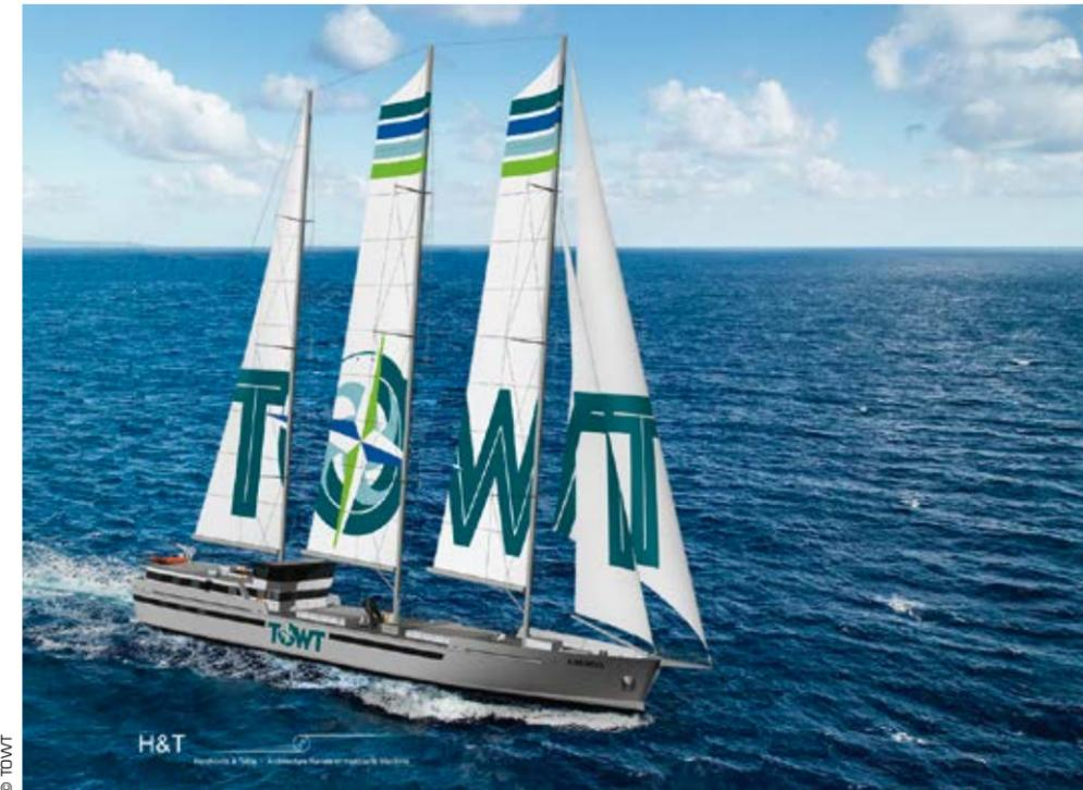
Le futur voilier-cargo construit et armé par TOWT, 60 mètres, 1 000 tonnes, 10 nœuds.
